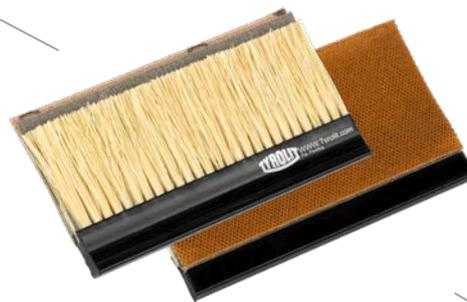
Par rapport aux lamelles de type FINISH D101, celles de type D101 PLUS sont dotées d'un support en tissu supplémentaire qui renforce la stabilité. Les lamelles TYROLIT POWER sont fabriquées avec un support en filet revêtu de diamant. Ce revêtement spécialement conçu empêche l'encrassement des lamelles et augmente considérablement la longévité
