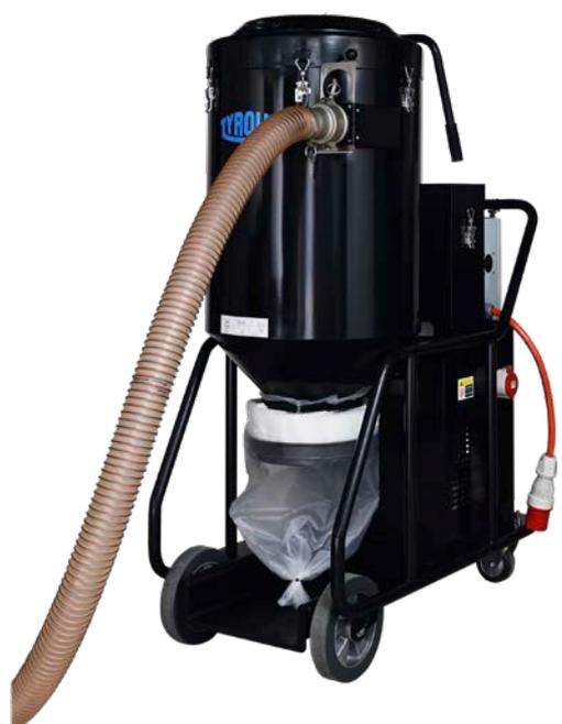
Il sistema di aspirazione VCE7500D convince per la sua combinazione di elevata portata d'aria e sottovuoto ed è dotato di un pre-separatore integrato. Il sistema funziona con la tecnologia a ciclone, il pre-separatore, 15 pre-filtri e due filtri HEPA. Il sistema di aspirazione è
