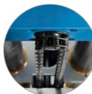
Principe de guidage à 2 colonnes avec entraînement par chaîne
