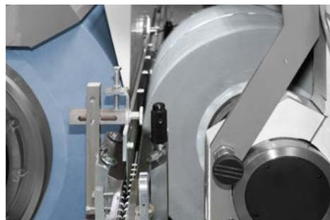
**+ Pression d'appui constante :** La matrice de liaison élastique compense les irrégularités de la pièce à usiner et génère ainsi une pression d'appui uniforme sur toute la longueur de la meule.
