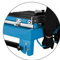
Pieds rabattables, roues de transport et poignées de transport assurant une manœuvrabilité optimale sur le lieu d'utilisation
