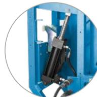
Funcionamiento silencioso gracias al tensor de hilo hidráulico
