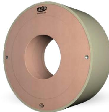
**+ Individuell gefertigt:** STARTEC CG Diamantschleifscheiben werden individuell gemäß Kundenanforderung gefertigt und sind in allen gängigen Spezifikationen erhältlich. Der Schleifbelag kann zudem durch Kombination verschiedener Korngrößen über die Scheibenbreite für die Schrupp-, Schlicht- und Polierbearbeitung gestaltet werden.
