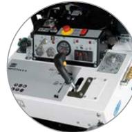
Sicheres Umpositionieren der Säge dank Leerlaufstellung
