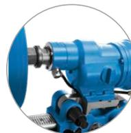
3 velocità, lubrificazione a bagno d'olio e pompa dell'olio per gli ingranaggi, frizione di sicurezza per il sovraccarico
