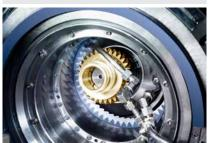
Systemlösung: MIRA REX Honringe sind in ihrer Auslegung und Spezifikation optimal auf die Verwendung mit MIRA DDG Diamant Abrichtzahnrädern abgestimmt.
