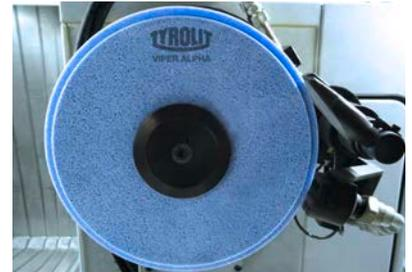
**+ Kühler Schliff:** Der speziell entwickelte Sinterkorund sorgt für einen besonders kühlen Schliff sowie geringe Schleifkräfte.
