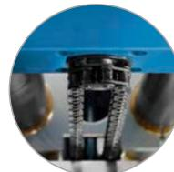
2-Säulen-Führungsprinzip mit Kettenantrieb
