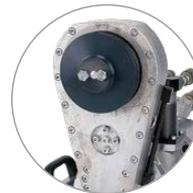
Getriebeschwenkarm mit Schnelltrennflansch für einfachen Blattwechsel
