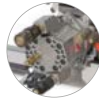
Hauptmotor mit Leckölschluss
